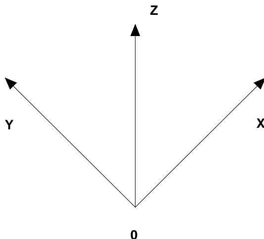
Il sistema di riferimento globale, rispetto al quale va riferita l'intera struttura, è costituito da una terna di assi cartesiani sinistrorsa O,X,Y,Z (X,Y, e Z sono disposti e orientati rispettivamente secondo il pollice, l'indice ed il medio della mano destra, una volta posizionati questi ultimi a 90° tra loro).
