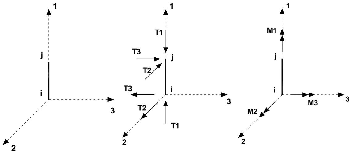
Definiti i e j come i due nodi iniziale e finale del pilastro, viene individuato un sistema di assi cartesiani 1-2-3 locale all'elemento, con origine nel Nodo i così composto:
