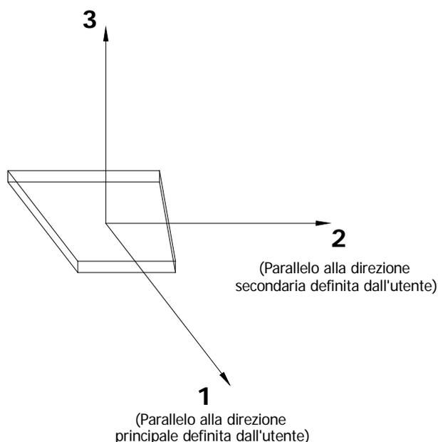
In maniera analoga a quanto avviene per i setti, ciascuna soletta è caratterizzata da un sistema di riferimento locale 1,2,3 così definito:
